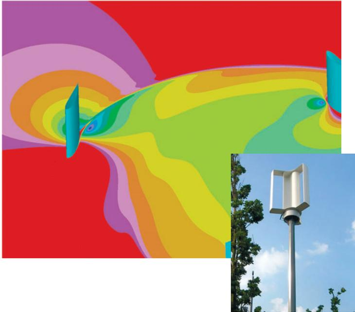
*Abbildung 2: Momentanwert der Geschwindigkeit in einer Ebene durch Vertikalturbine*
