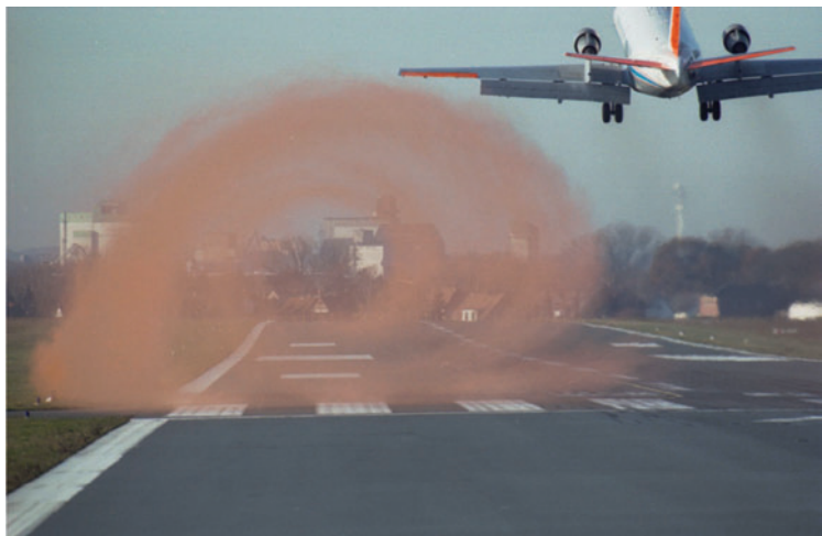
Abbildung 1: Bedingt durch Wirbelschleppen müssen größere Abstände eingehalten werden, die die mögliche Anzahl von Starts und Landungen reduzieren.
