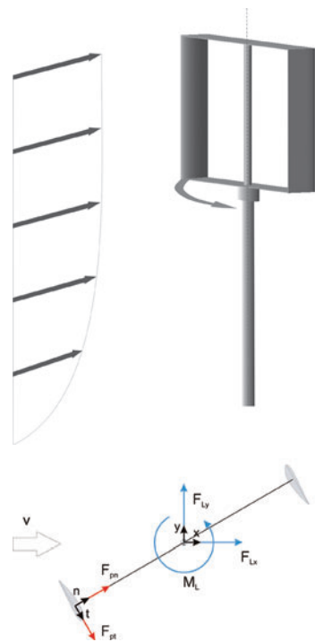
Abbildung 1: Prinzipskizze einer vertikalen Windkraftanlage und Koordinatensysteme
